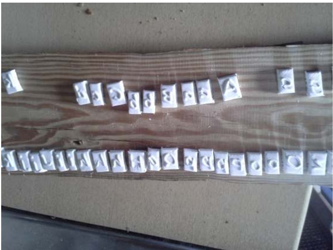
Positive, sowie negative, spiegelverkehrte Buchstaben gefräst. Erste fertige Druckbuchstaben
